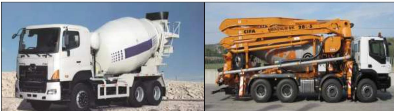
Εικόνα 4-4: Μπετονιέρα/ Αντλία σκυροδέματος
