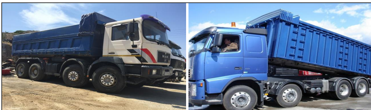
Εικόνα 4-2: Φορτηγά μεταφοράς αδρανών
